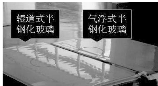
图6 不同物理钢化工艺的半钢玻璃的外观对比
